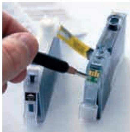
» Fenixove kartuše za Canon zahtevajo premestitev kontrolnega čipa z originalne kartuše na združljivo.
