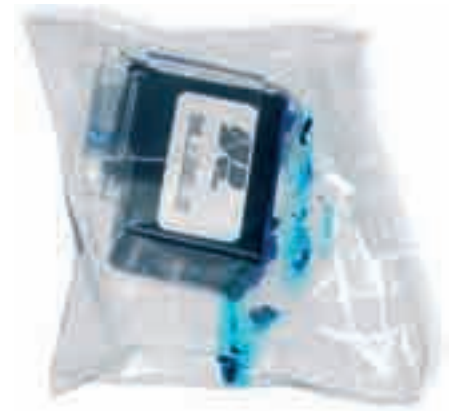
» Kakovost nekaterih izdelkov je slaba. Na sliki kartuša Fenix za tiskalnik HP, ki je puščala, še preden smo odprli originalno embalažo.
