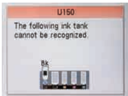
» Prvi poizkus premestitve čipa na kartuši Canon se ni dobro končal, saj tiskalnik združljive kartuše z originalnim čipom ni več prepoznal.
