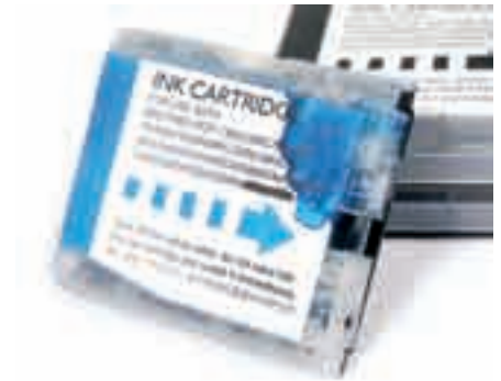
» Nekatero združljivo kartuše prav nemarno puščajo skozi luknjico za vsrkavanje zraka, ki nadomešča porabljeno barvilo v kartuši.
